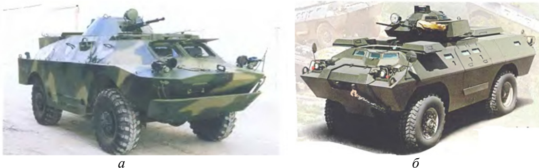
Рис. 3. Конструктивна форма броньованого корпусу бойових розвідувально-дозорних машин БРДМ-2 (СРСР) (а) та Драгун (США) (б)
