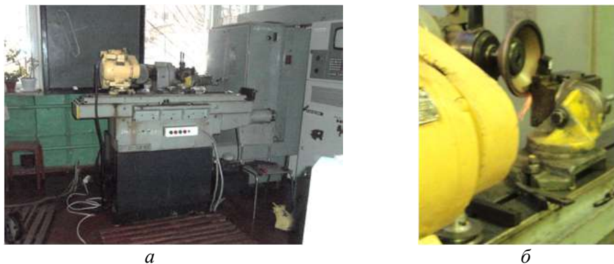
Рис. 12. Шліфування твердосплавної пластини на верстаті моделі В3208Ф3
