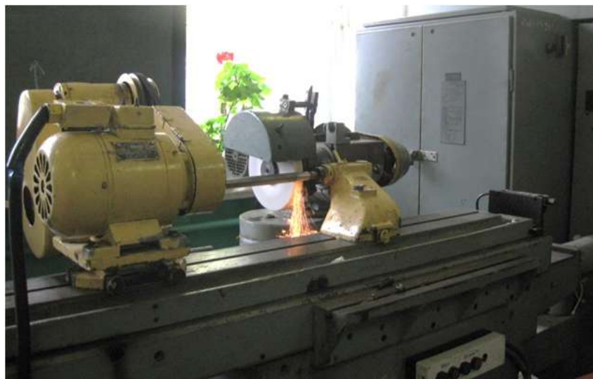
Рис. 3. Шліфування циліндричного вала зі схрещеними осями абразивного круга та деталі на верстаті моделі В3208Ф3
