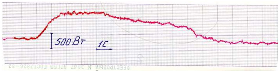
Рис. 8. Результати вимірювання потужності шліфування із схрещеними осями абразивного круга та циліндричного вала
