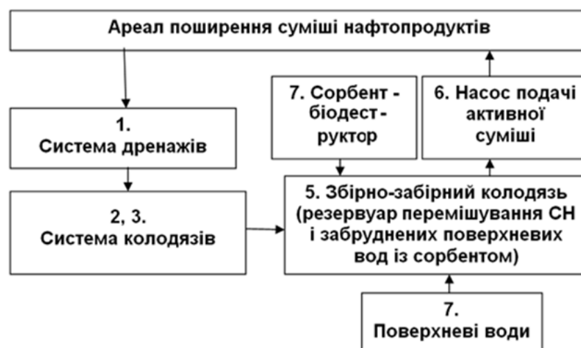
Рис. 4. Блок-схема очищення території від СН методом оборотної біоремедіації
