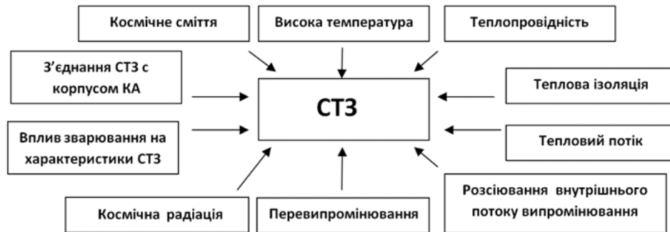
Рис. 1. Вплив факторів космосу на систему теплового захисту космічних апаратів
