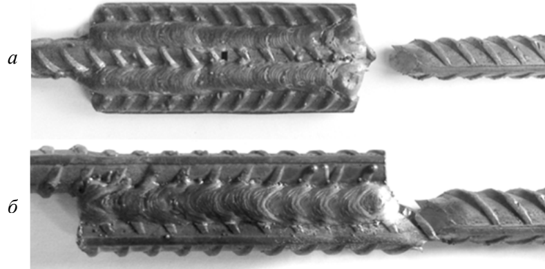
Рис. 8. Зразки зварних з'єднань арматури після натурних випробувань на розрив: а – стикових з парними накладками; б – напусткових
