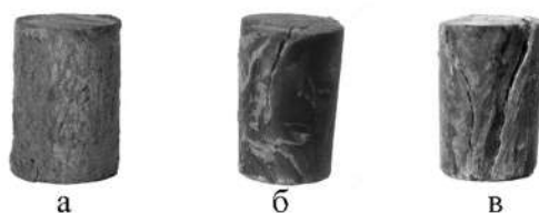
Рис. 3. Характер разрушения композитов, содержащих: 60 мас. % волокна Русара (а), 60 (б) и 70 (в) мас. % Танлона
