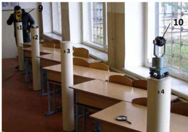
Рис. 1. Вимірювання відстаней за допомогою тахеометра Trimble 3305 DR
