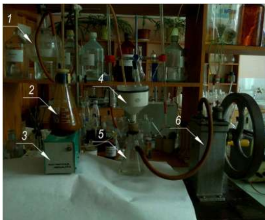
Рис. 1. Схема пілотної установки дослідження кінетики окиснення сполук заліза у зваженому шарі осаду із матриксів біо-мінералів, залізобактерій та гідроксиду заліза: 1 – ємність вихідної води; 2 – ємність реактору; 3 – магнітна мішалка; 4 – фільтр; 5 – ємність збору фільтрату; 6 – насос Камовського
