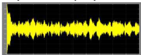
Рис. 5. Тимчасова діаграма коливань виконавчої ланки мобільного верстата при вимушених гармонійних коливаннях
