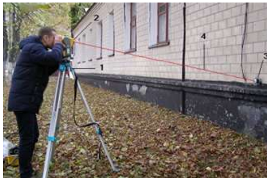
Рис. 3. Вимірювання відстані за допомогою електронного тахеометра Trimble 3305 DR у комплекті з новим пристроєм для прив'язки до стінних знаків
