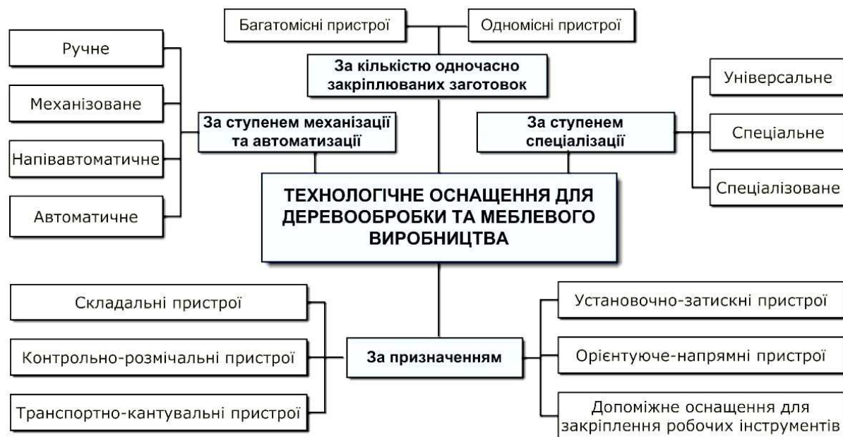
Рис. 1. Класифікація технологічного оснащення для деревообробки
