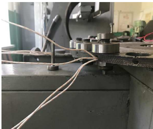
Рис. 8. Вимірювання температури за допомогою термопар «хромель-капель»
