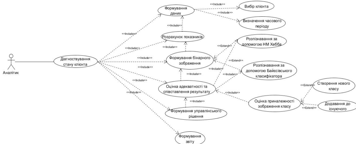
Рис. 3. Діаграма варіантів використання, що деталізує діагностування стану клієнта
