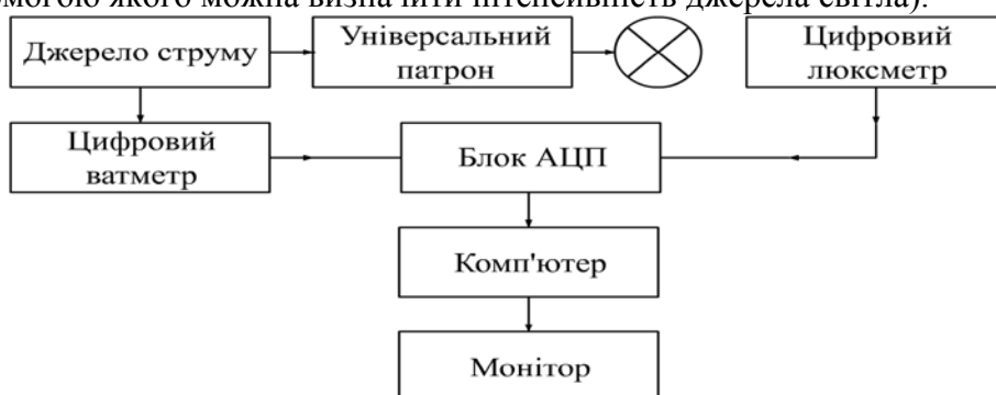
Рис. 3. Блок-схема приладу для визначення ефективності джерела світла
