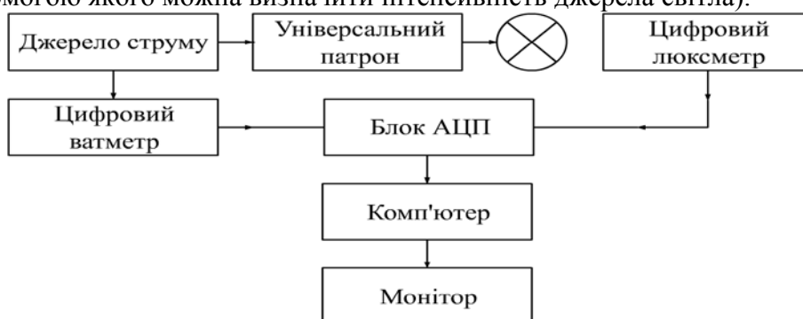
Рис. 3. Блок-схема приладу для визначення ефективності джерела світла
