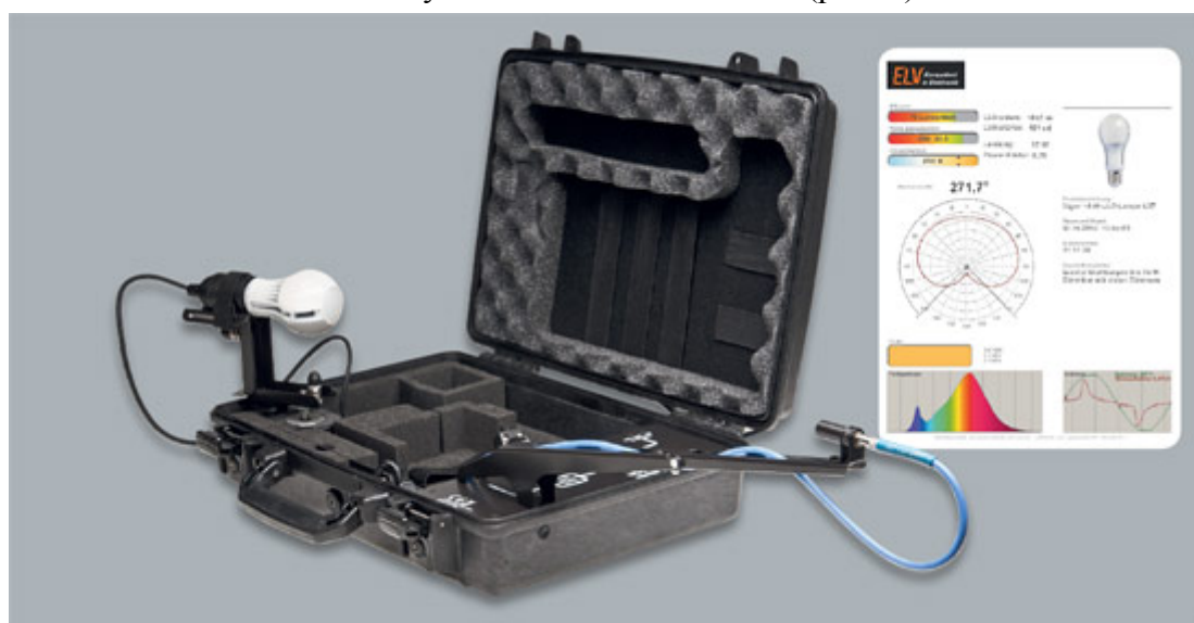
Рис. 2. Вимірювач параметрів ламп Viso LightSpion компанії
