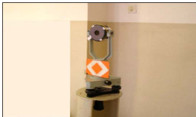
Рис. 2. Відбивач з блендою
