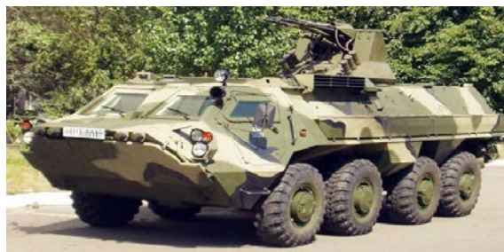
Рис. 11. Бронетранспортер БТР-4Е із бойовим модулем БАУ-23
