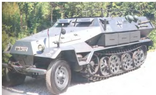
Рис. 1. Напівгусеничний бронетранспортер «Ганомак» (Германія, 1940)
