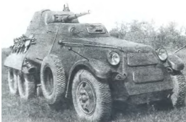
Рис. 3. Бронеавтомобіль БА-11 6х4 (СРСР, 1940)
