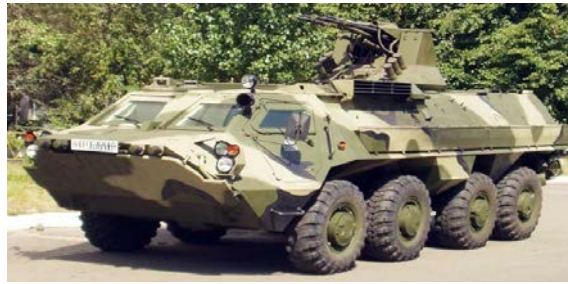
Рис. 11. Бронетранспортер БТР-4Е із бойовим модулем БАУ-23
