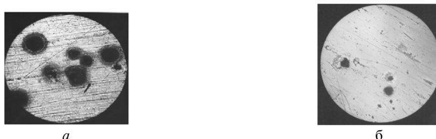
Рис. 8. Сліди дії електророзрядних процесів на поверхні алюмінію у площині зварювання (пропали): а – фізичний контакт не утворився; б – у місцях пропалів непровари, х140
