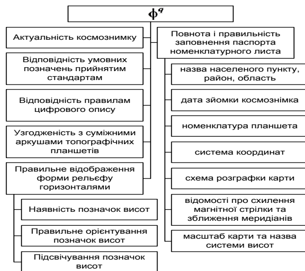
Рис. 3. Дерево показників якісного оцінювання топографічного планшета
