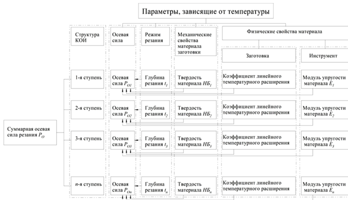
Рис. 1. Факторы, влияющие на изменение силы резания и крутящего момента при обработке отверстий КОИ, зависящие от температуры
