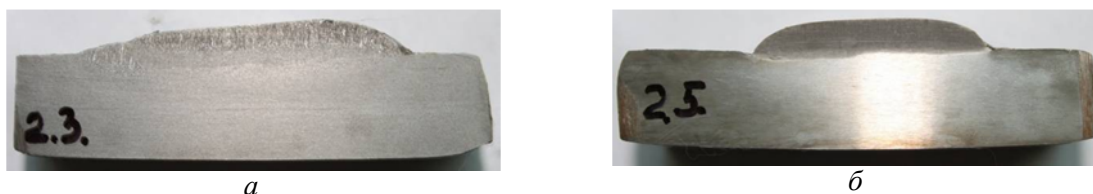
Рис. 3. Характер макроструктуры наплавки ленточным электродом без принудительного переноса электродного металла: а – Св-08-А, V=60 мм, \delta=1,5 мм; б – ст. 3, V=40 мм, \delta=0,5 мм
