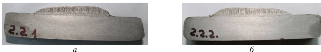
Рис. 1. Характер макроструктуры наплавки ленточным электродом с принудительным переносом электродного металла Св-08-А: а – B=40 мм, \delta=1,5 мм; б – B=50 мм, \delta=1,5 мм
