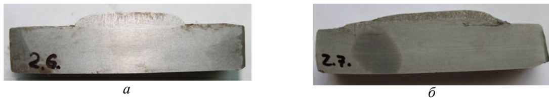
Рис. 2. Характер макроструктуры наплавки ленточным электродом: а – с принудительным переносом электродного металла ст. 3, V=50 мм, \delta=1,5 мм; б – без принудительного переноса электродного металла Св-08-А, V=60 мм, \delta=1,5 мм
