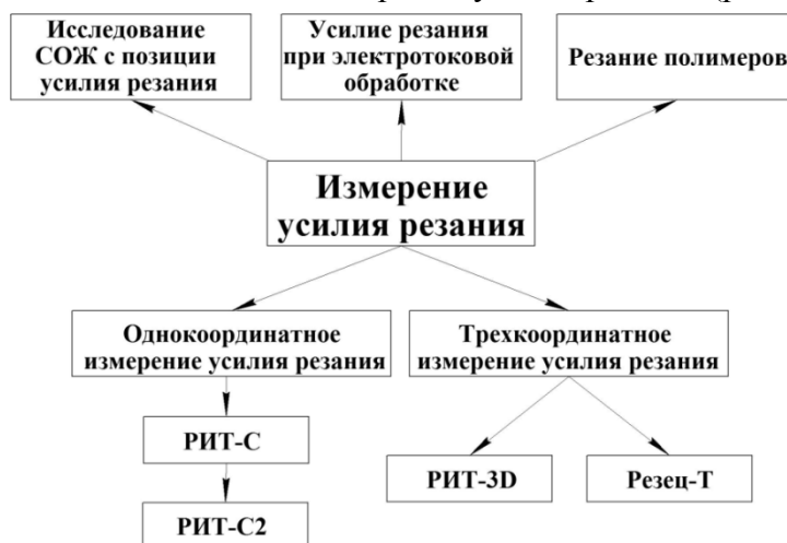
Рис. 3. Перспективные направления исследований в области измерения усилия резания
