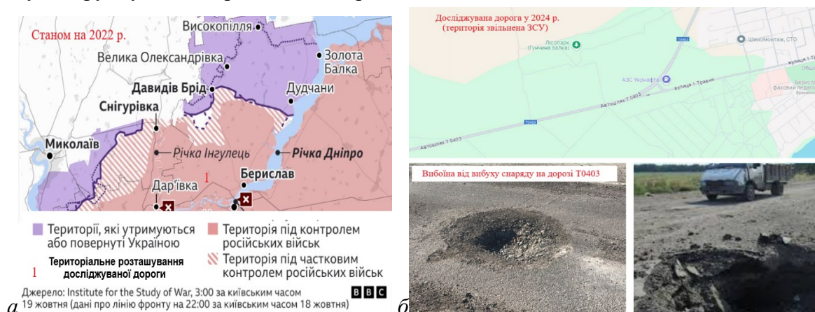
Рис. 1. Розташування досліджуваної дороги під час окупації рф у 2022 р. (а) та основні типи пошкоджень дороги, виявлені у 2024 р. (б)
