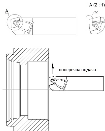
Рис. 6. Застосування державки «TCBNL 2525 M12»
