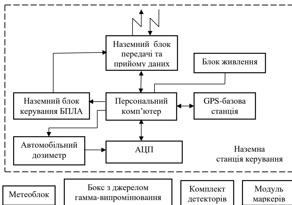
Рис. 3. Блок-схема обладнання СКТРЗ на наземному транспортному засобі [25]
