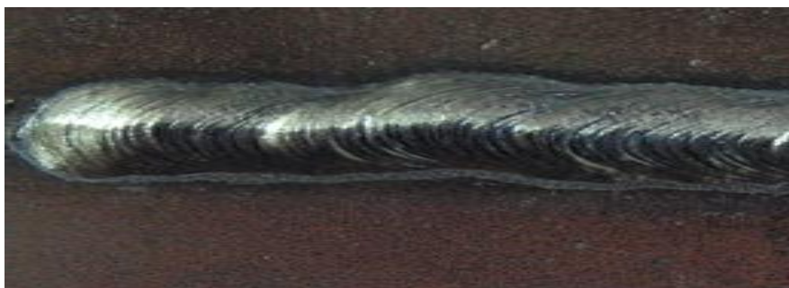
Рис. 3. Зовнішній вигляд металу швів, отриманих у результаті експериментальних досліджень джерел живлення для імпульсно-дугового зварювання: а) частота струму 10 Гц; б) частота струму 100 Гц
