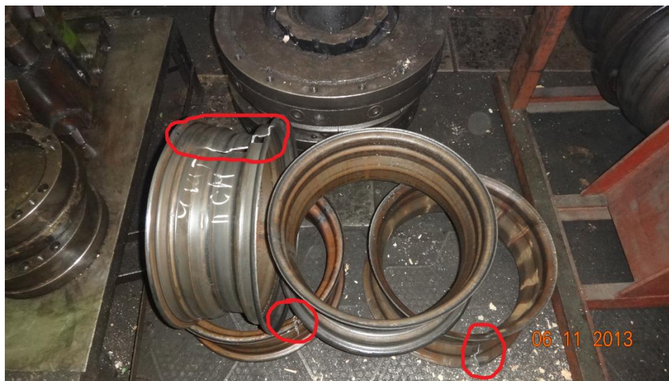
Рис. 4. Руйнування зварного шва у процесі пластичної деформації циліндричної заготовки ободу колеса
