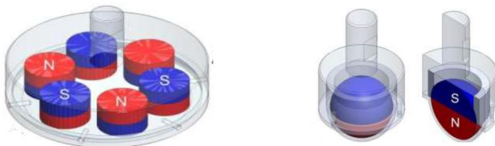
Рис. 1. Схематичне представлення торцевих головок з сталими високоенергетичними магнітами [28]
