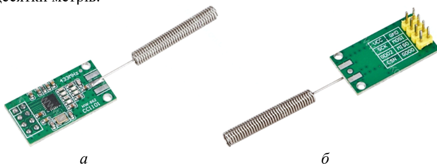
Рис. 1. Зовнішній вигляд модуля бездротової передачі даних HC-11: а – вид зверху і б – вид знизу
