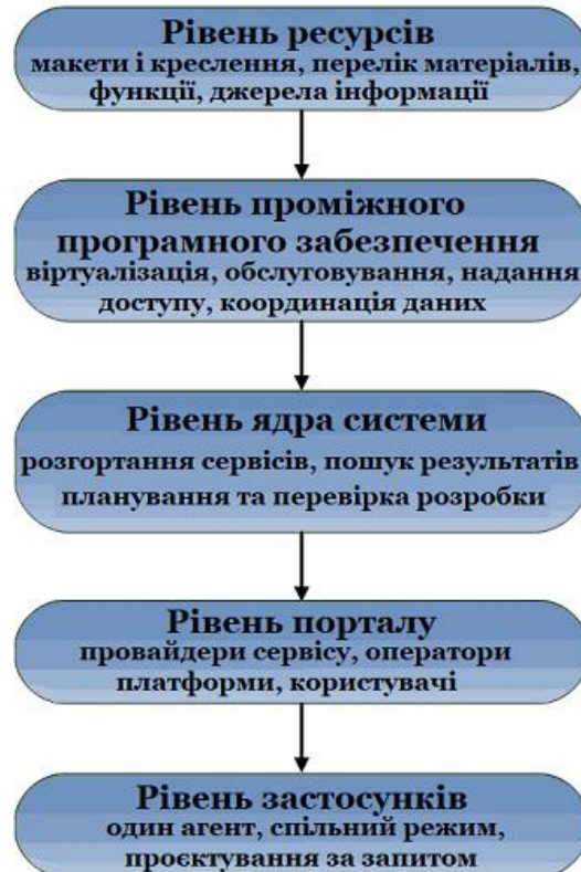
Рис. 2. Рівні системи обслуговування хмарного виробництва
