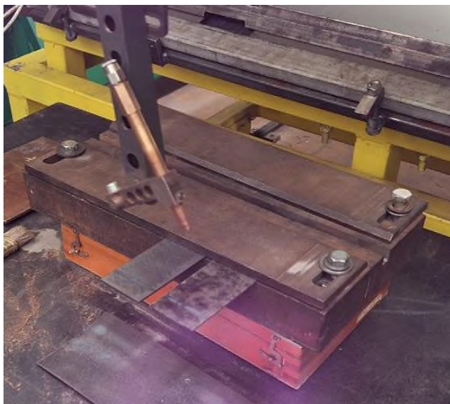
Рис. 5. Закріплення зразків та їх позиціонування під обробку
