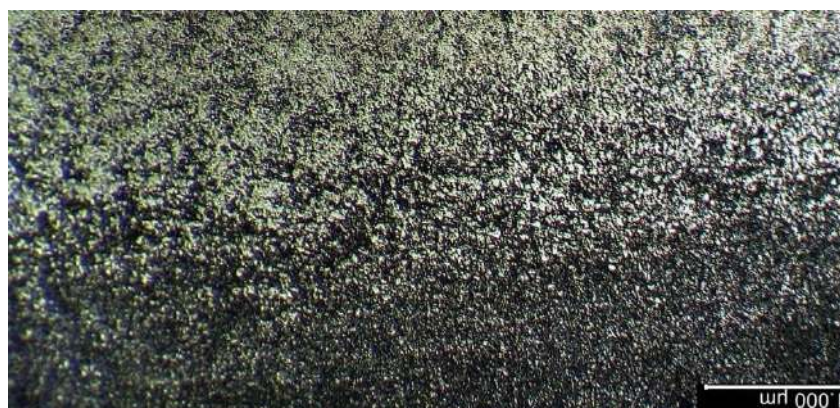
Рис. 15. Мікроструктура перехідної зони, збільшення \times 200 після шести проходів лазерного опромінення, попередньо гартований зразок Сталь 65Г
