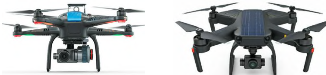
Рис. 3. Зовнішній вигляд БПЛА з автоматичним перемиканням на зовнішнє живлення (а) та БПЛА на сонячних батареях (б)
