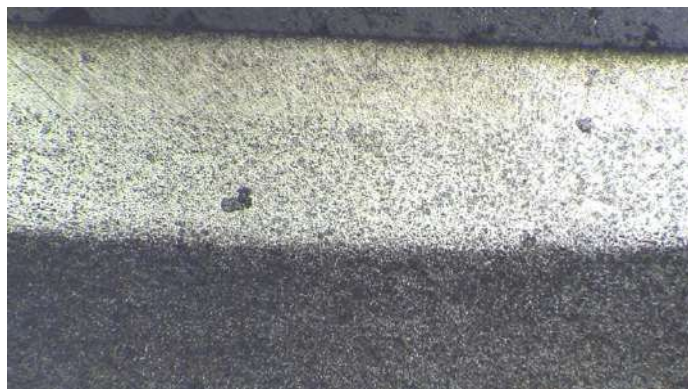
Рис. 13. Мікроструктура області лазерного проходу, збільшення \times 100 після одного лазерного опромінення
