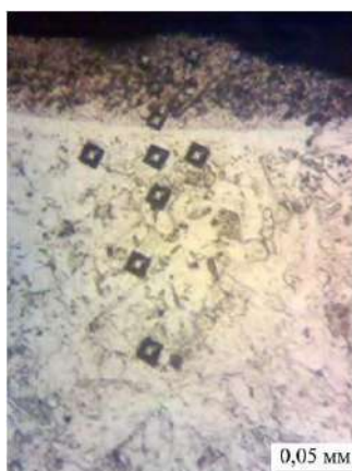
Рис. 3. Мікроструктура після ЕІЛ твердим сплавом Т15К6 (а) і показники якості отриманого поверхневого шару (б)
