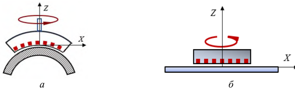
Рис. 10. Безконтактний спосіб просторово адаптивного регулювання швидкості і реалізації реверсивного руху в модульних двигунах: а – обертального руху (SF 2.2х,у); б – поступального руху (PL 2.2х,у)
