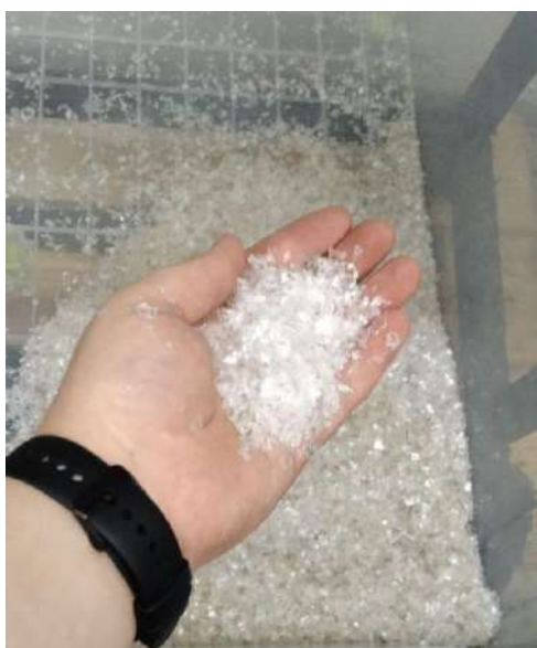
Рис. 1. Результати механічного подрібнення пластикових пляшок
