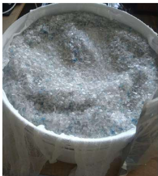
Рис. 2. Процес висушування подрібненого вторинного PET-G
