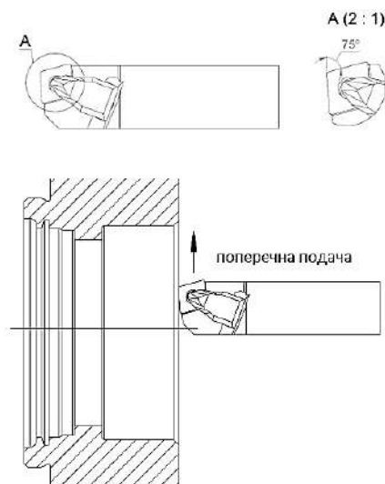
Рис. 6. Застосування державки «TCBNL 2525 M12»
