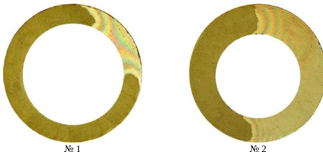
Рис. 6. Знімки зон з'єднання, що відповідають скляним деталям із різною величиною периметрів бокових поверхонь ( U_{зв} = 800 \text{ В} ; Q = 4000 \text{ мкКл} )
