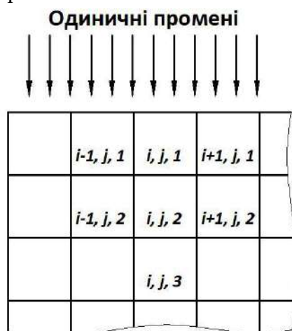
Рис. 1. Матеріал мішені у вигляді елементарних об'ємів
