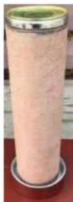
Рис. 1 – Димова шашка на основі KNO 3 як один з елементів запропонованої авторами [18; 19] напівавтоматичної системи аерозольного маскування
