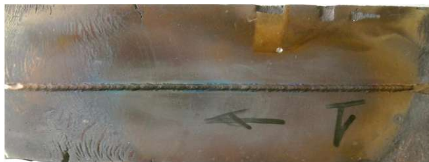
Рис. 1. Внешний вид образца со швом жаропрочного титанового сплава с повышенным содержанием алюминия, выполненного ЭЛС
